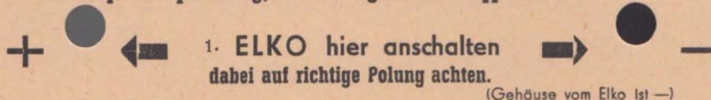
**Gütebeurteilung:** Ein Elko schlägt selten durch, es wird nur der Reststrom höher Zeiger darf bei gutem Elko nur bis zu dem unten angegebenen, nach  $\mu\text{F}$  bezifferten Wert gehen.
